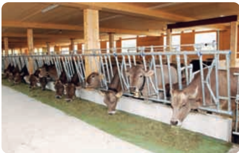
Das Sicherheitsfressgitter Safety schützt die Tiere vor Unfällen.
